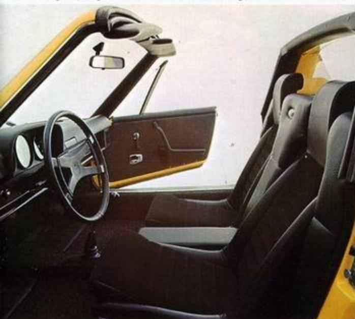
De anatomisk rigtigt formede sæder med indbyggede nakkestøtter og sidepolstring er placeret i den bedst offjedrede del af vognen: mellem de to aksler.
