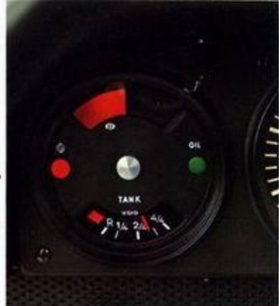
I kombi-instrumentet med temperatur-, tank- og oliemåler er der tillige anbragt en advarselslampe, som lyser rødt for antrukne håndbremse.
